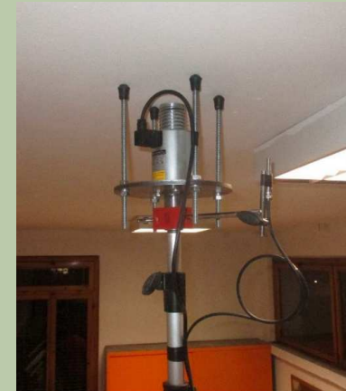
Diagnosi mediante spintore meccanico e microfono
