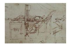
L'acqua, scorrendo in una canaletta alla base della macchina, mette in movimento la ruota a pale, la quale aziona una biella che, trasformando il moto rotatorio in moto alternato, permette alla lama dentata verticale di tagliare il tronco.
